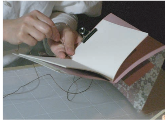
4: 折ったり貼ったり表紙の準備を終え、糸で綴じていきます。重なる紙の穴に糸を通すのは案外大変な作業で、コツを掴むまで四苦八苦の方も。
